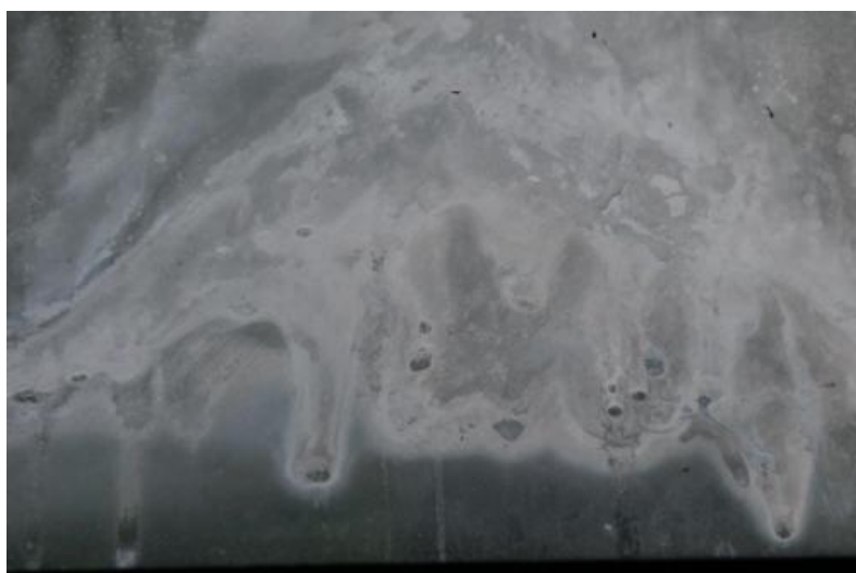
Rysunek 7 Skorodowane szkło
