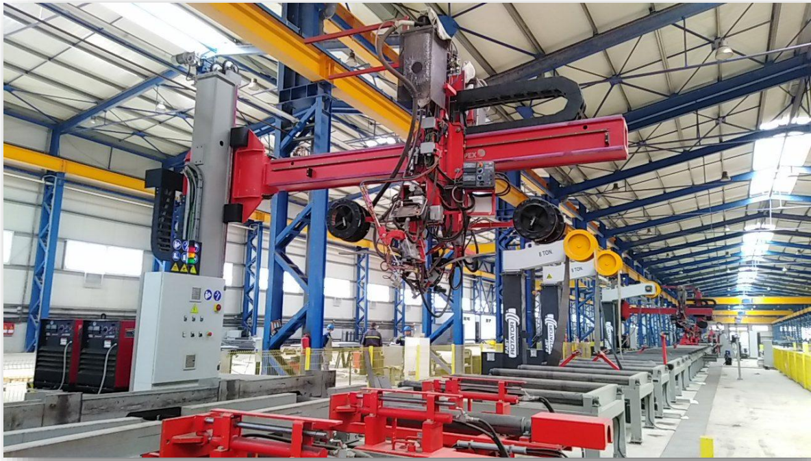
Figure 1- 6 Soudeuse H-PRS (Métal structure)
