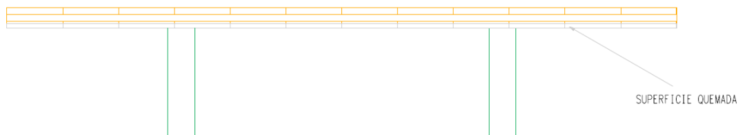
Ilustración 67. Comportamiento frente al fuego del CLT T: sección reducida del CLT.
