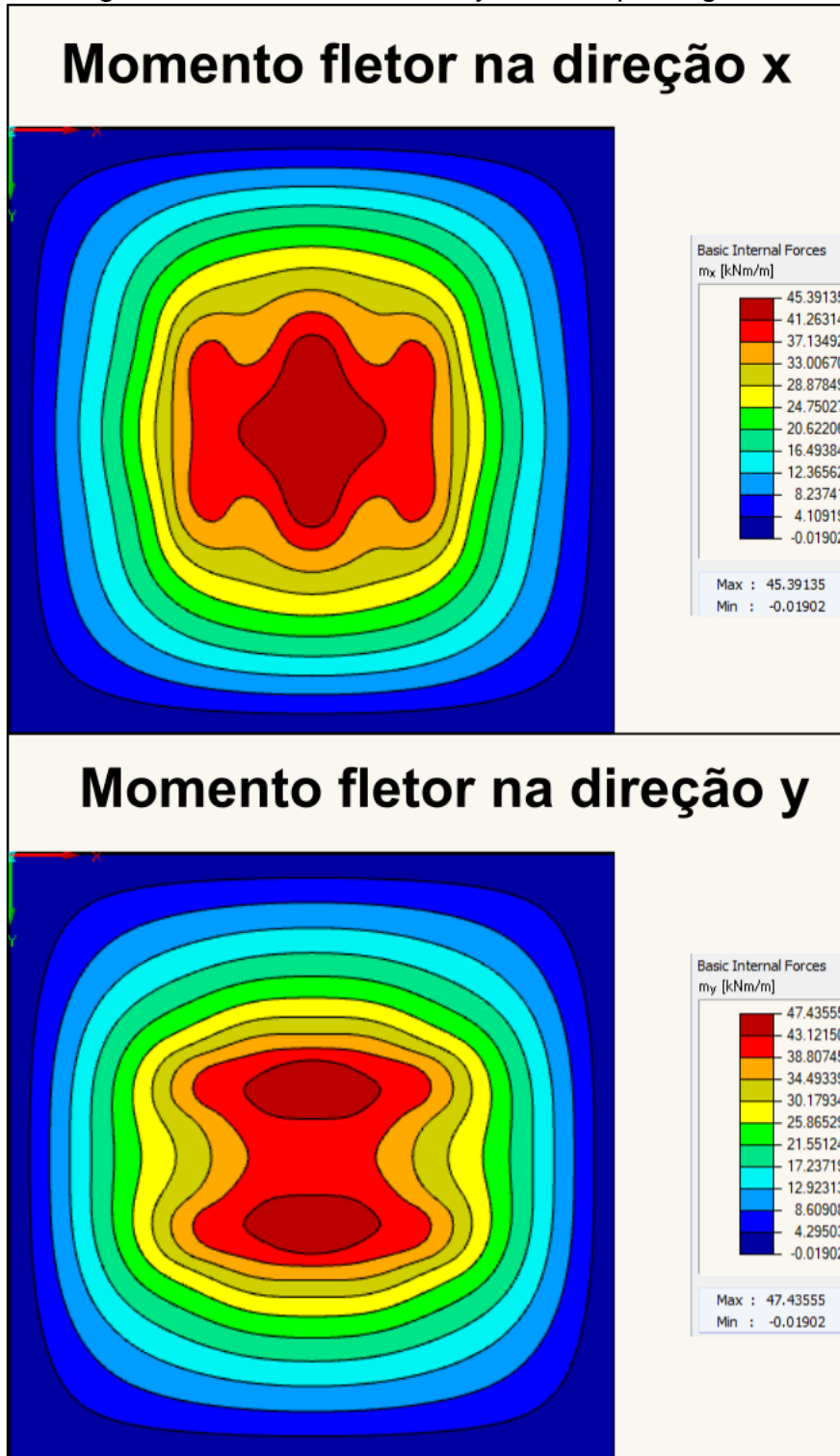
Figura 51 – Diagrama do momento em x e y do exemplo 2, gerado no RFEM 5.
